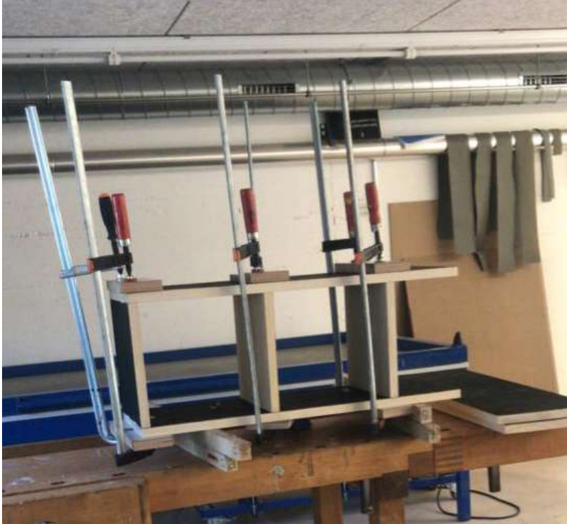
Planskizze und Prozessbild beim verleimen
